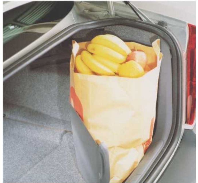
Eingebauter, aufrollbarer Gepäcksicherungsgurt fixiert z. B. Einkaufstaschen (Option)
